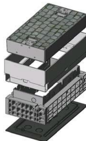
Stahl auspflasterbar B125/D400 H=340mm
