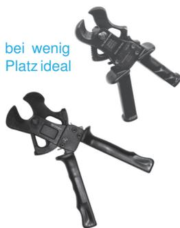
170270 **FKS 25 Frontkabelschneider** bis 25mm Außendurchmesser, Cu 150(185)mm<sup>2</sup>, Alu 150(185)mm<sup>2</sup>, auch für feindrahtige Leitungen, Einhand-Bedienung, nachjustierbarer Schneidandruck, Länge: 240mm, 0,95kg
