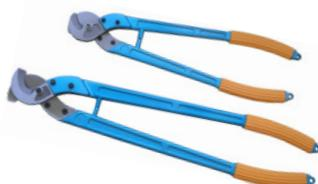
**Kraft-Cut Kabelschneider** Alu-Griffe mit Öse, extra leicht, hochvergüteter Schneidkopf für Präzisionsschnitt, sichelförmige, nachstellbare Schneiden, **für Kupfer- und Alu-Kabel**, nicht geeignet für Stahldrähte, Kabel mit Tragseil und hartgezogene Kupfer-/Aluleiter
